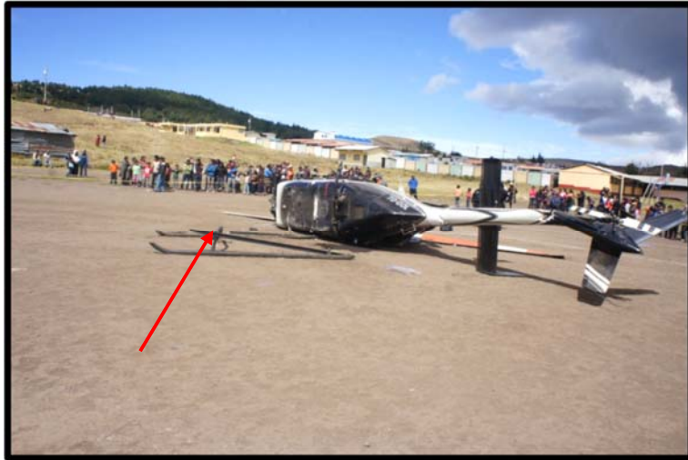
Fotografía No. 5 Vista del tren de aterrizaje desprendido del fuselaje.
