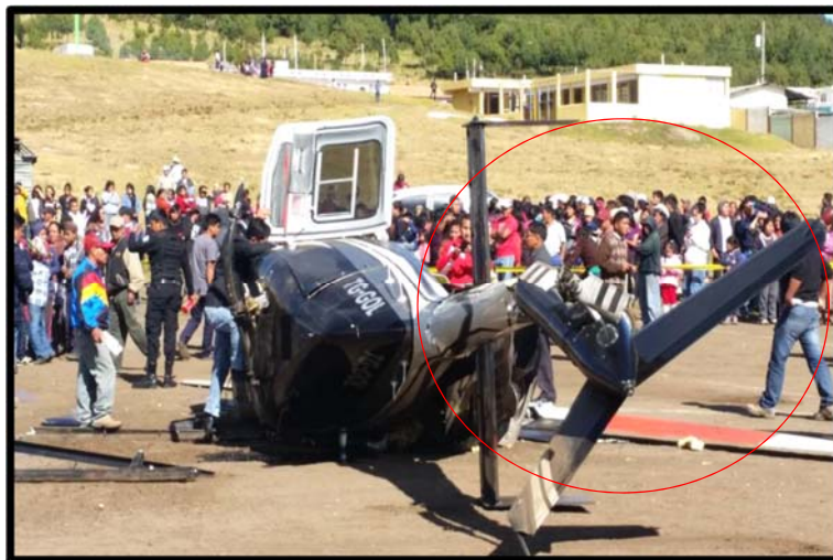
Fotografía No. 14 Daños al estabilizar vertical y botalón de cola.
