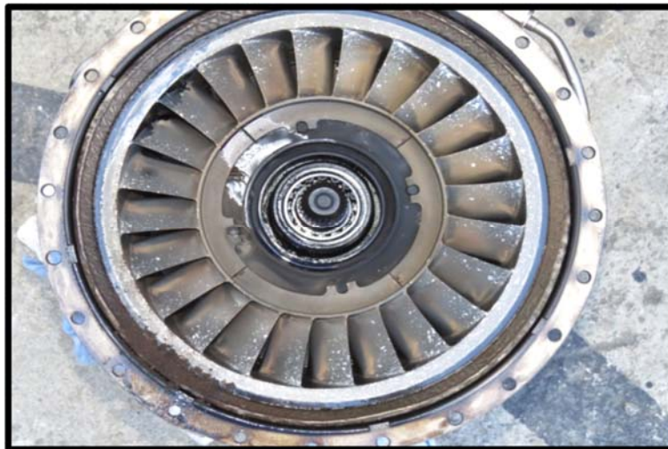
Fotografía No. 28 Vista superior de la rueda No. 3 de la turbina
