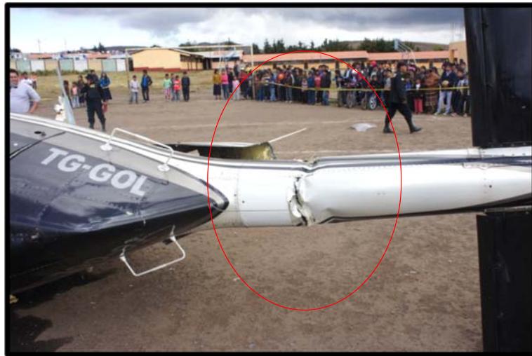
Fotografía No.11 Botalón de cola con daños por stress de impacto.
