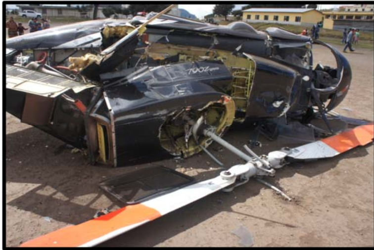
Fotografía No. 13 Daño total de los componentes dinámicos del helicóptero
