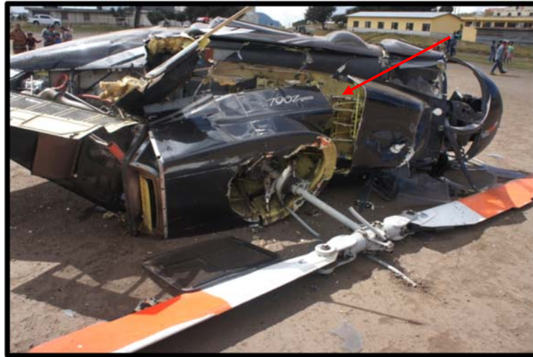
Fotografía No.09 Desprendimiento de la transmisión y del motor.
