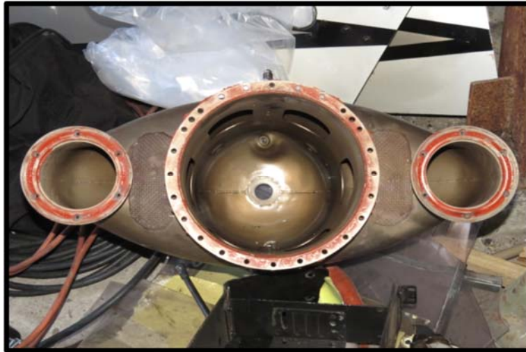
Fotografía No. 25 Vista frontal de la sección de la cámara de combustión.
