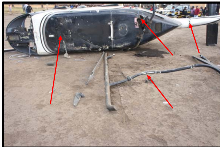
Fotografía No.10 Daños severos del fuselaje
