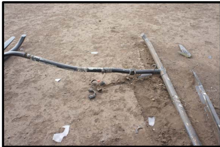
Fotografía No. 12 Tubos cruzados del tren de aterrizaje, vencidos por stress.
